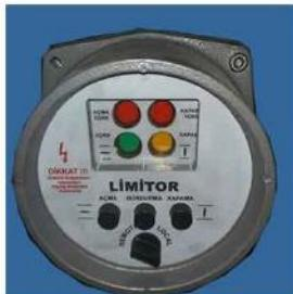
Aktüatör üzerinden Local olarak On-Off kumanda imkanı sağlar. Açıma-kapama Limit ve Açıma-kapama Tork sinyal bilgilerini gösterir. Remote-Local anahtarları ile kontrolün nereden yapılacağını belirler. Kontrol paneli tamamen türkçedir.
