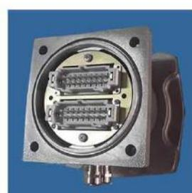
Duvar askı aparatı sayesinde Aktüatör montajının müdahale edilmesi zor olduğu noktalarda aktüatör vana üzerine bağlanıp kontrol kısmının kumandaya daha elverişli bir yere montajı yapılarak kumanda edilmesi sağlanır. Pin konnektör bağlantısı sayesinde bakım arıza onarım zamanlarında aktüatör kablo bağlantılarını kolayca söküp bağlamaya olanak verir.
